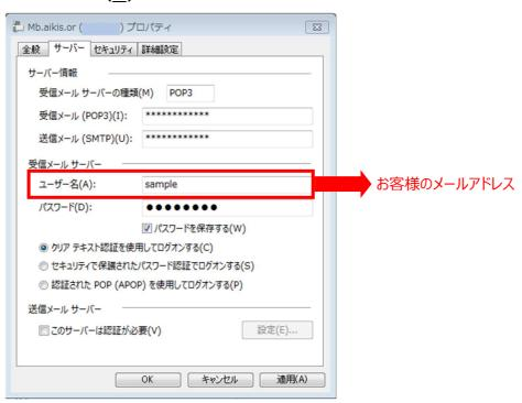
6. 変更完了後、[OK]をクリックします。
